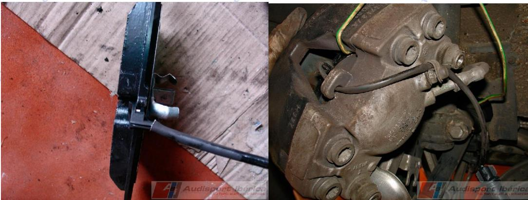
Para colocar el conector en su sitio: deslizar hacia arriba en el encaje
