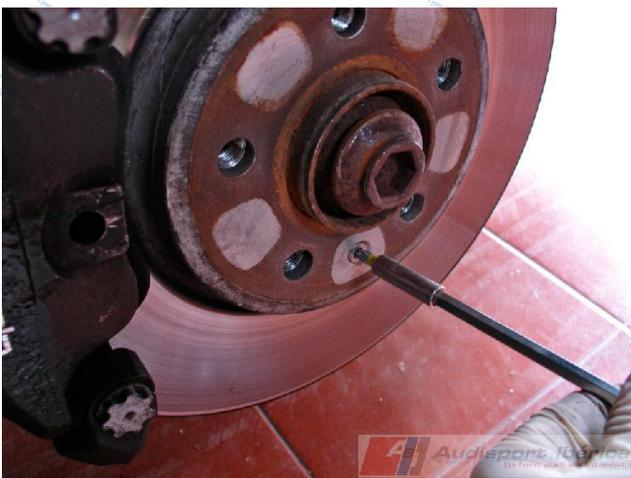
Aflojar los tornillos de pinza. Llave de tornillos hexagonal 13
