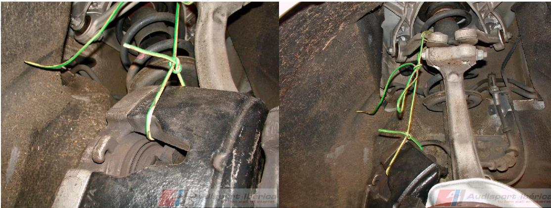
La pinza queda suspendida del brazo superior teniendo cuidado de no provocar esfuerzos al latiguillo. Aquí vemos la pinza con sus pastillas, dejamos sin quitar la pastilla interior para poder comprimir el pistón...
