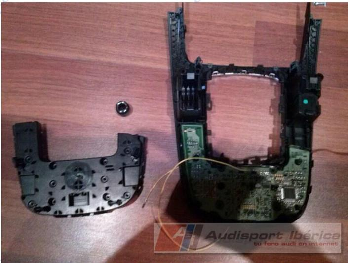
Una vez tenemos la placa sola, tenemos que conectar un cable al mosfet, lo que se ve en el círculo rojo (ese cable será alimentación 12v)
