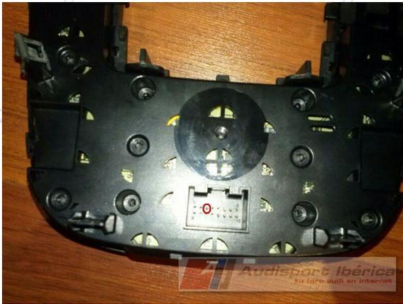
Una vez tenemos la consola montada es hora de cablear el conector, este viene numerado. En el borne 8 ponemos un cable que será el que de la masa a la consola, y en el borne 3 (ese es el que hemos puentado) le damos los 12 voltios que hemos comentado antes.
