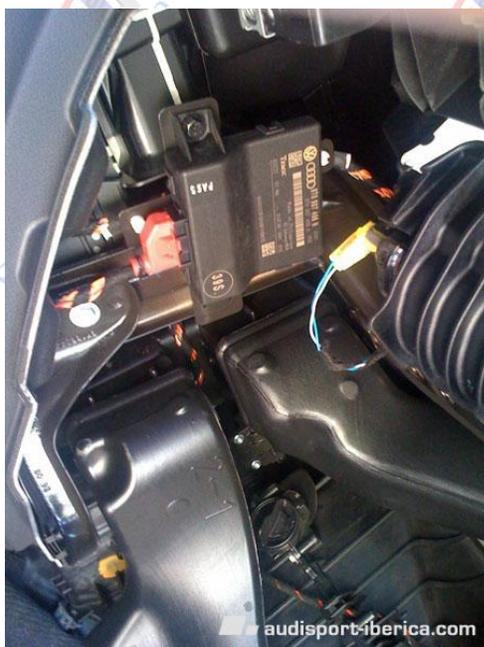
He desconectado los pin 10 y 20 que corresponden a la conexión CAN de la radio, y en su lugar he conectado la señal DIAG.1 (rotura de anillo) en el pin 10, y el conector con la fibra óptica. También he cambiado el gateway por el que lleva la conexión para fibra.
