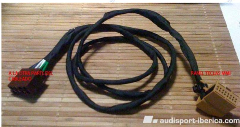
Cable para alimentación de la pantalla de 7" y la señal DIAG.1 (rotura de anillo) del gateway, en el otro extremo se conecta de nuevo al resto de cableado.
