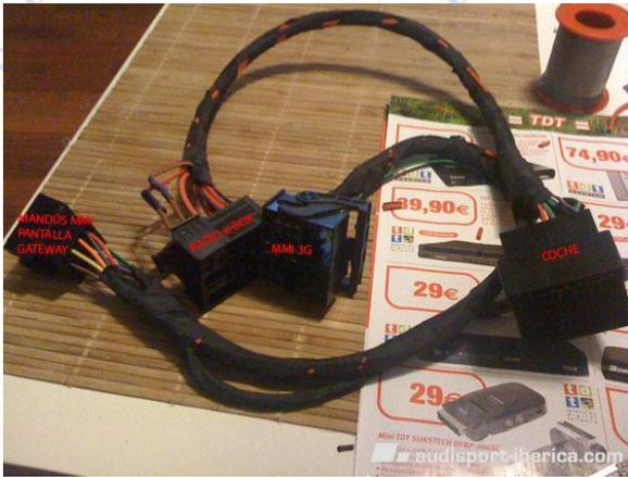
El conector que se ve a la izquierda lo he puesto para poder separar el cable en varias piezas, y así sea más fácil en futuro el poder desmontar cualquier cosa, a ese conector engancharé el cableado que viene del panel de teclas MMI (7 pines), la nueva pantalla de 7" (sólo para alimentación) y el cable con la señal DIAG. 1 que sacaré del gateway que está detrás de la guantera.
