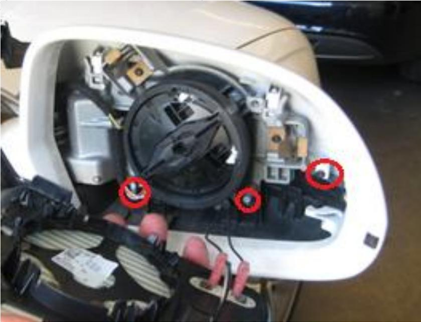
con un destornillador o con una herramienta de plástico presionar las 2 pestañas para poder sacar la carcasa, tire de la carcasa tirando suavemente hacia arriba y hacia afuera.
