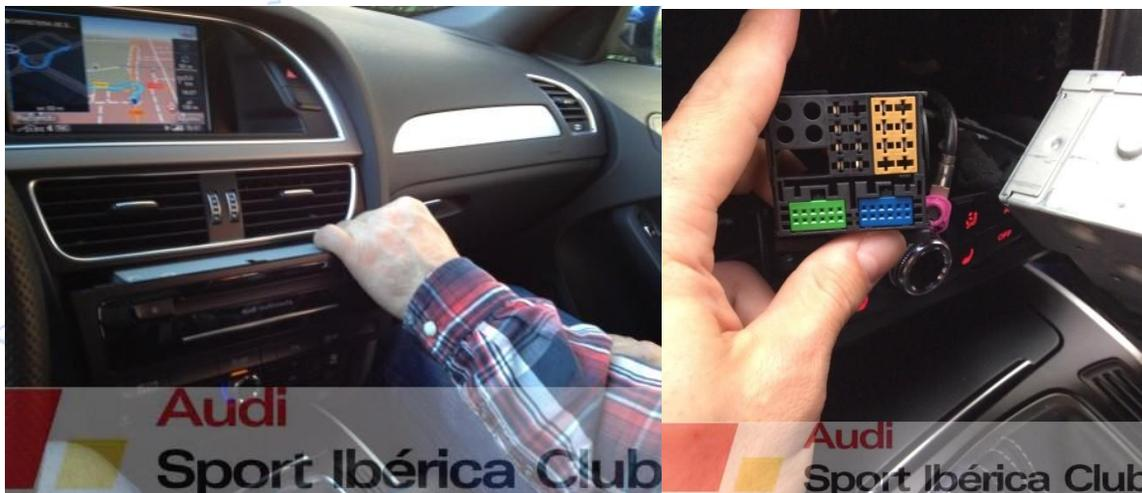
Una vez extraído el módulo del MMI, se trata de conectar los cables en el módulo trasero. Las conexiones se deben hacer de la siguiente forma:
