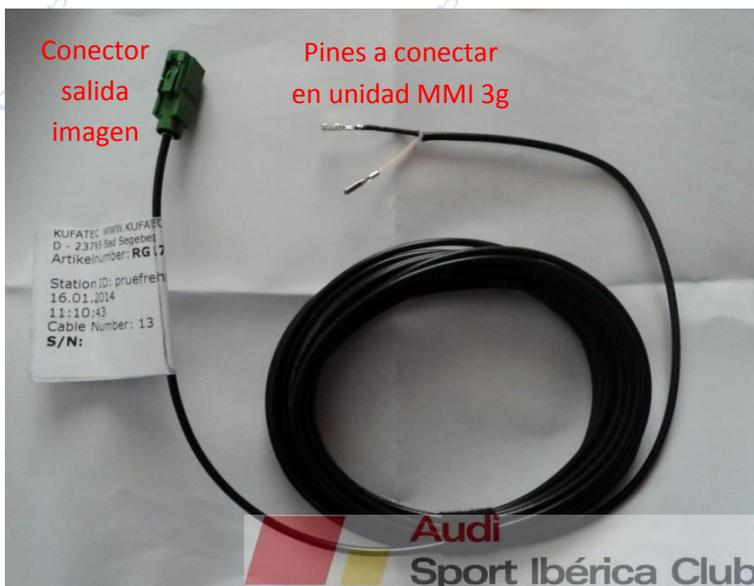
Cable de centralita que da corriente a la cámara y va conectado a caja fusibles y conector CAN Hi-Lo de la red del vehículo:
