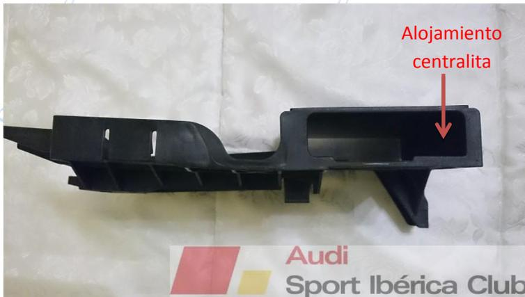
Soportes para cableado en portón (8P0971848K y 8P0971848L):
