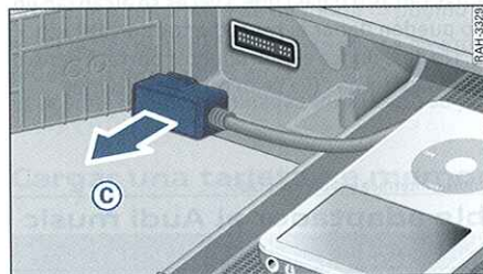
Fig. 9 Cable adaptador: Desacoplar el conector desbloqueado del Audi music interface
