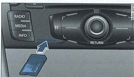
Fig. 5 Introducir una tarjeta de memoria
