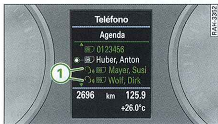
Fig. 53 Registro de la agenda de la instalación para el móvil con un identificador
