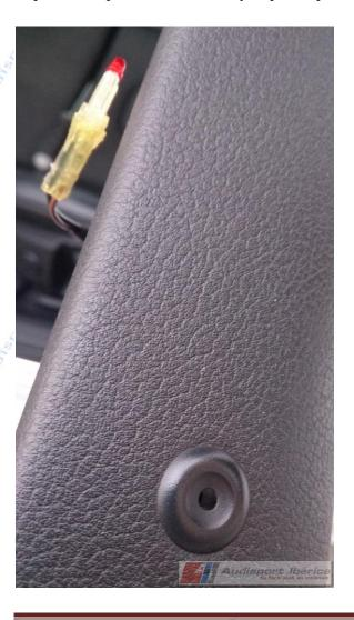
Después, debemos extraer el recubrimiento de plástico transparente de la parte negra que se lo sujeta con el clip a su sitio, para ello, pasamos un cúter o navaja por los laterales de esa pieza de plástico negro y vamos haciendo un poco de fuerza para que se suelte de ella, lleva un anclaje central que después con una dremel tendremos que retirar,
