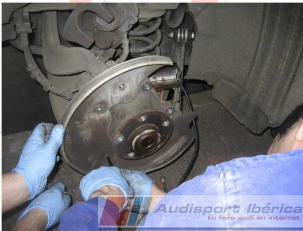
Con la mangueta ya accesible intentamos sacar el conjunto buje+rodamiento sin desmontarla.
