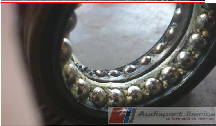
Sacadas las bolas se aprecia el deterioro de la pista interna del rodamiento exterior. ¡Normal que sonase el rodamiento!
