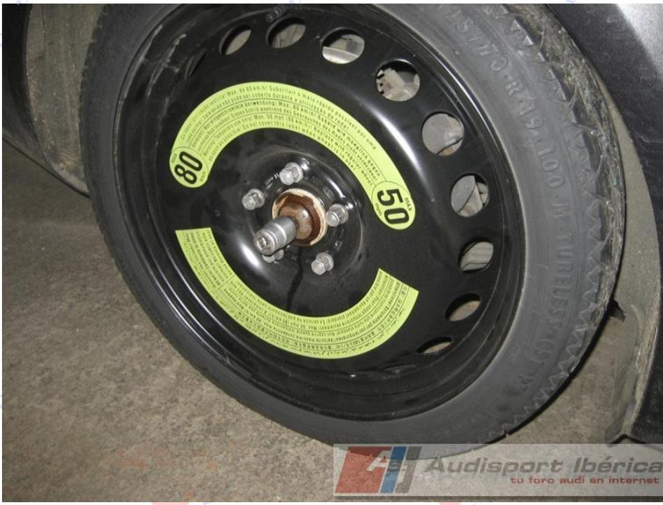
Usamos un tubo como palanca, este tornillo se aprieta a 200 Nm.
