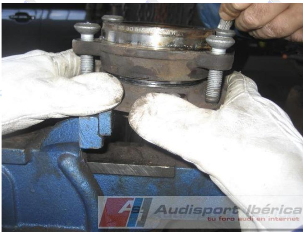
La pista interna del rodamiento la sacamos con métodos coercitivos, jeje. Lo que nos interesa es desnudar el buje para colocar el nuevo rodamiento
