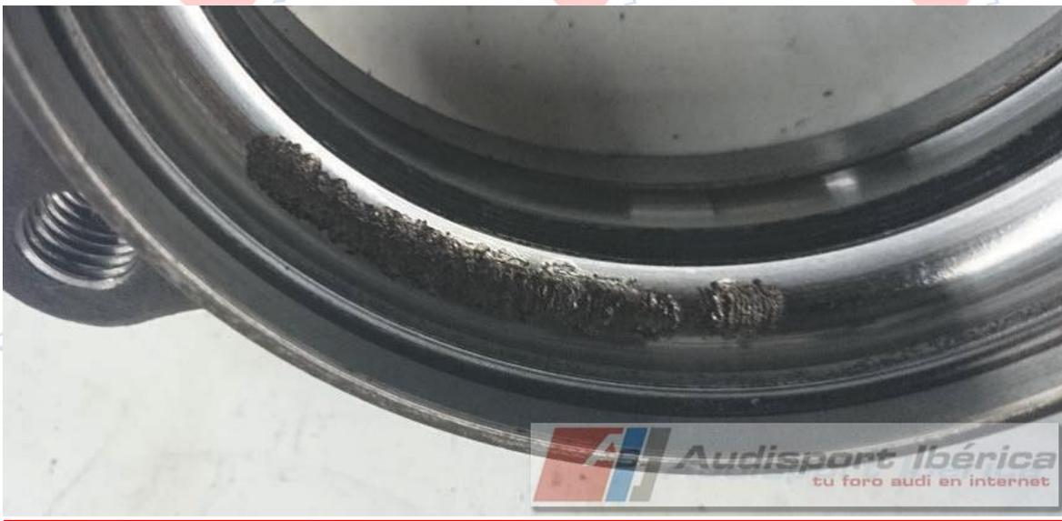
Este defecto en la pista parece debido a un material con defectos internos y muy próximos a la superficie, que fueron aflorando por el lógico rozamiento y presión de las bolas. Ahora a esperar que el nuevo venga con material de aun más calidad y dure Km y km.
