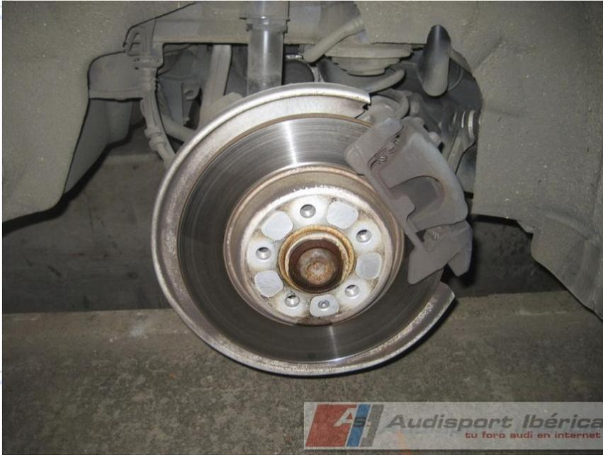
Pinza fuera, está sujeta al portapinzas por dos únicos tornillos; usamos llave fija 13 y otra fija 15 a fin de retener un vástago que hace oscilar la pinza entorno al disco de freno.
