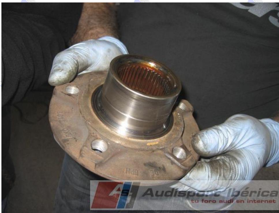
Colocamos el nuevo rodamiento, lo suyo es utilizar una prensa o gato que aplique la fuerza equilibradamente y exclusivamente sobre el eje interno del rodamiento que irá deslizando sobre el buje.
