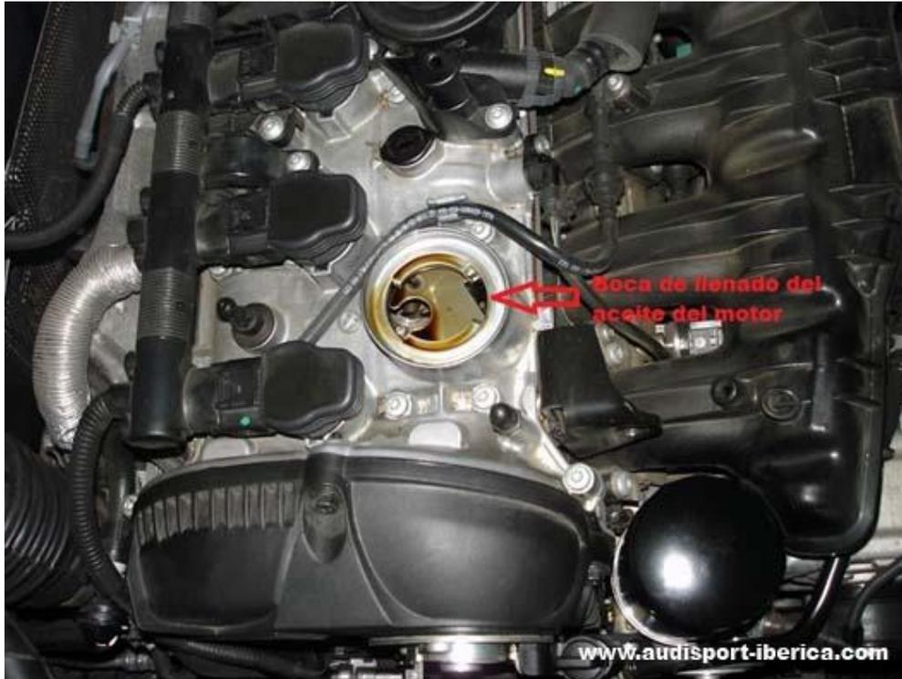
Limpiamos la junta de goma del tapón de la boca de llenado de aceite del motor y volvemos a tapar la boca de llenado con el tapón roscando el mismo 1/4 de vuelta a derechas. Observad que en el tapón Audi recomienda Castrol como lubricante a emplear.
