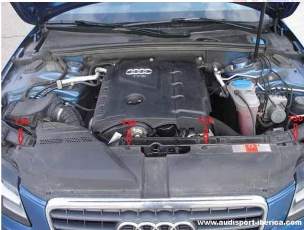
Con un destornillador con punta T25 desenroscamos los 2 tornillos que lleva la boca de entrada de aire de la admisión:
