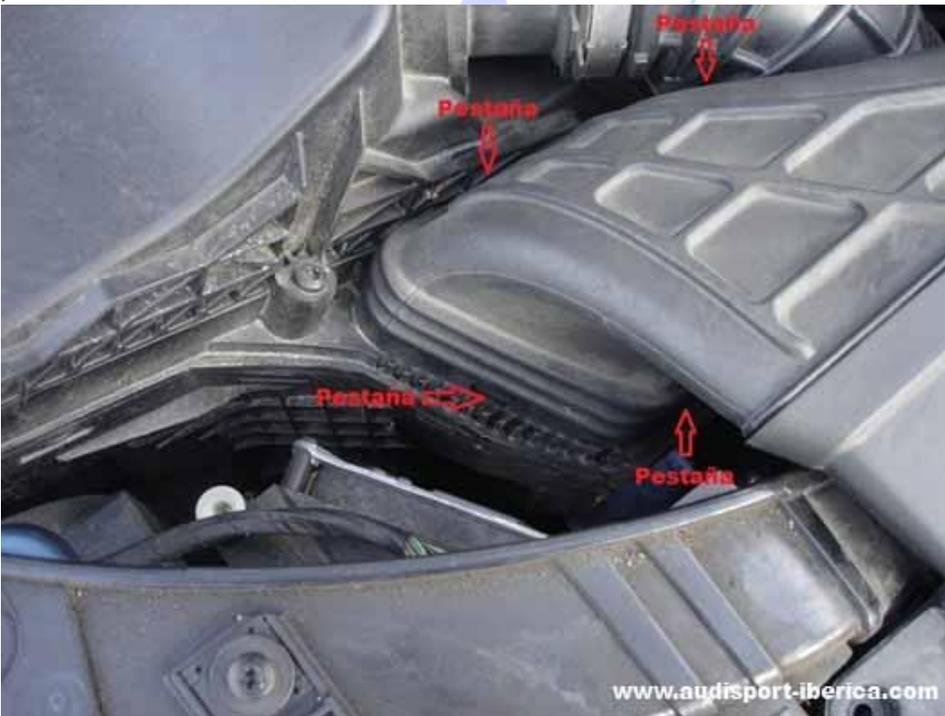
Con un destornillador con punta T25 desatornillamos los 2 tornillos del caudalímetro y lo separamos de la carcasa superior del filtro de aire:
