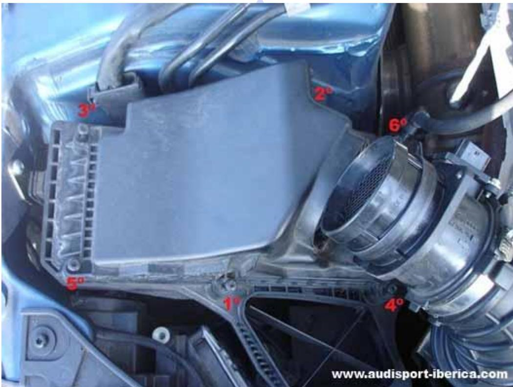
Una vez atornillada la carcasa superior del filtro de aire, montamos el caudalímetro y lo atornillamos, procedemos a montar la boca de entrada de aire de admisión y el panel frontal de forma inversa a como lo hemos desmontado.
