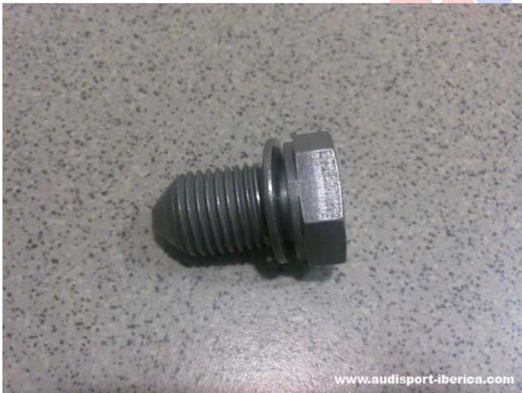
También tenéis la opción si queréis aprovechar el tornillo del cárter de aceite que desmontéis de poner solamente un anillo junta al mismo con referencia de recambio **N 013 849 3** al precio de 0,39€. Previamente tenéis que desmontar el anillo junta usada del tornillo con una fresa o Dremel.
