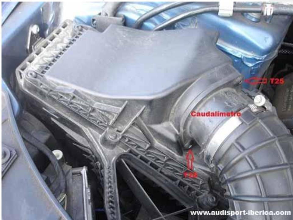
Una vez desmontado el caudalímetro de la carcasa superior del filtro de aire, con un destornillador con punta T30 desatornillamos los 6 tornillos de la carcasa superior del filtro de aire para desmontarla y poder retirar el filtro usado de aire:
