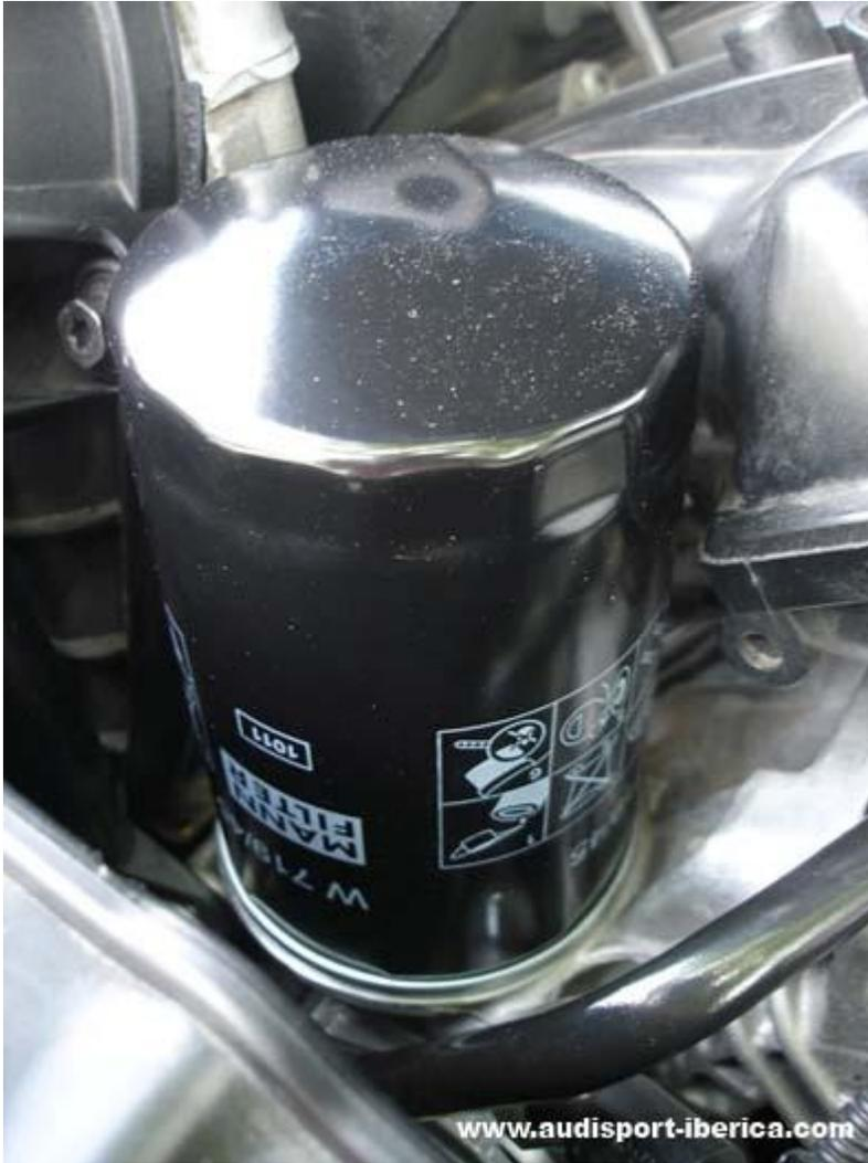
La referencia de recambio original de Audi del filtro de aceite es 06J 115 561 B y el fabricante del mismo es MANN como podéis comprobar en las 2 fotos del filtro original del Audi:
