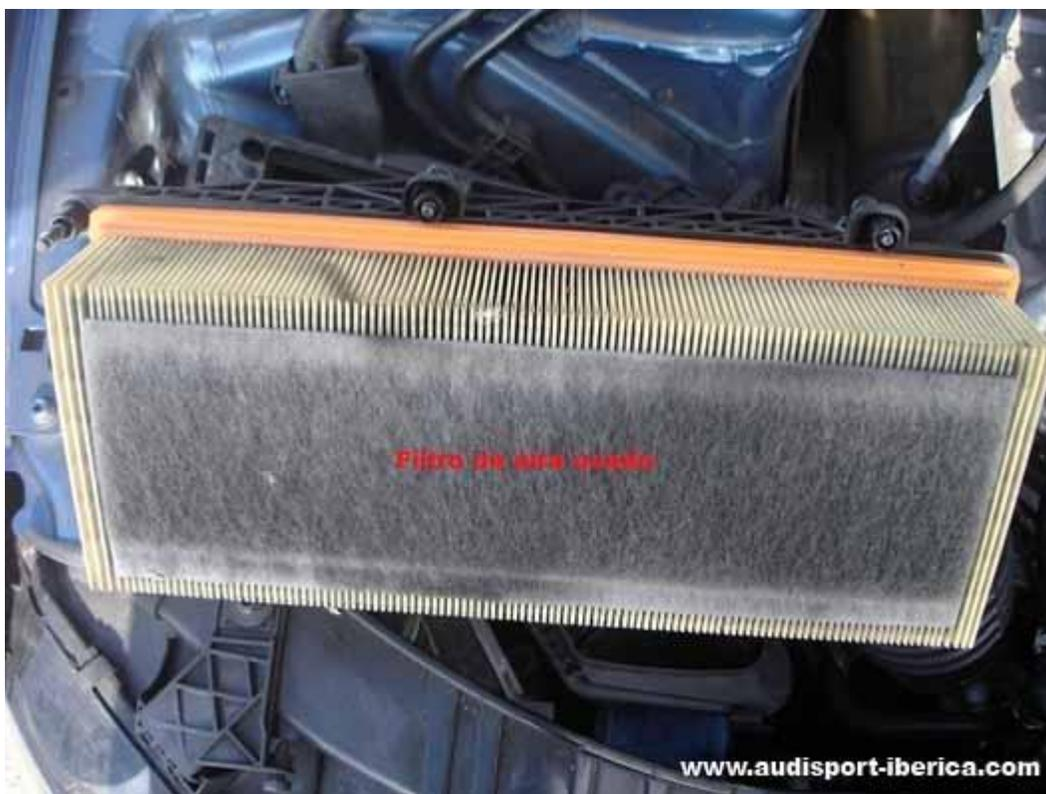
*Si observamos restos de suciedad y partículas dentro de la carcasa inferior del filtro los retiramos o aspiramos antes de montar el filtro de aire nuevo.*
