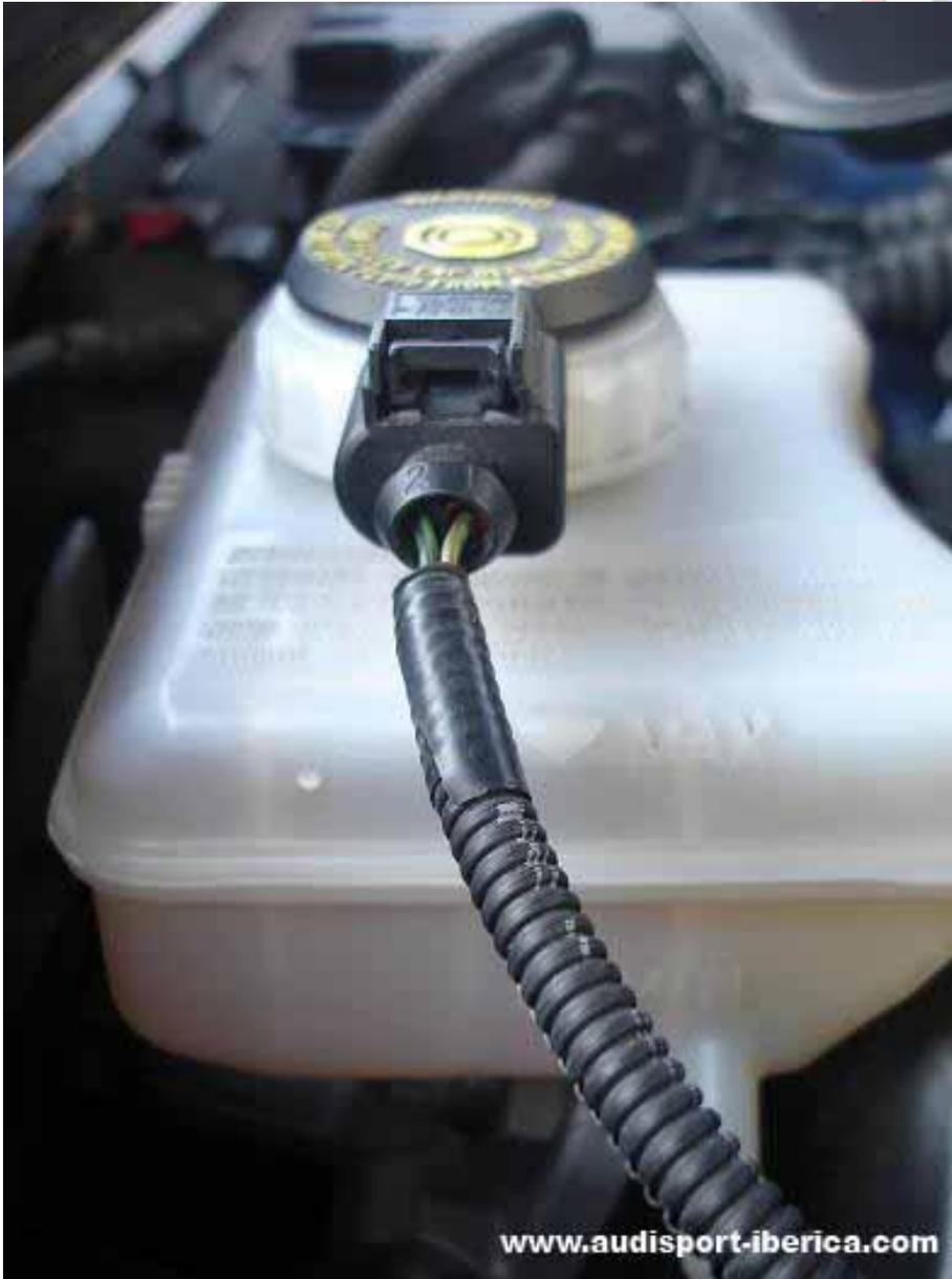
Si no se encuentra a un nivel correcto el depósito reponemos con líquido de frenos especificación DOT 4 solamente.
