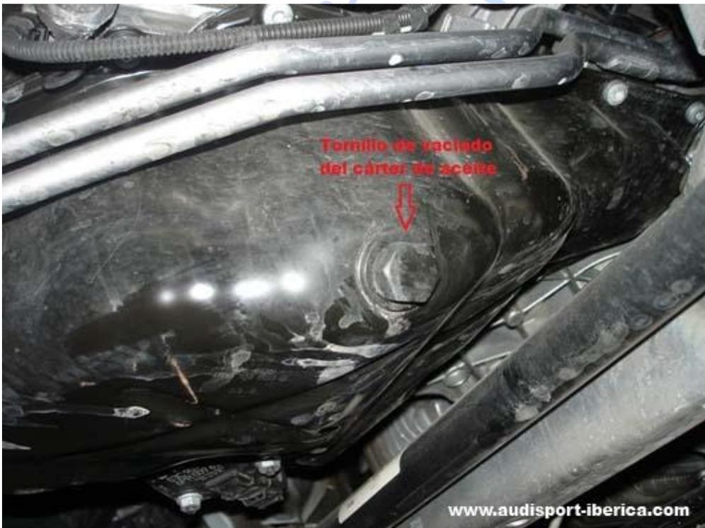
*Desenroscamos el tornillo de vaciado del cárter de aceite con una llave fija de estrella de 19 mm. o con una llave autocle con vaso de 19 mm. girándolo a izquierdas y desechamos el aceite usado en un recipiente para su posterior reciclaje:*
