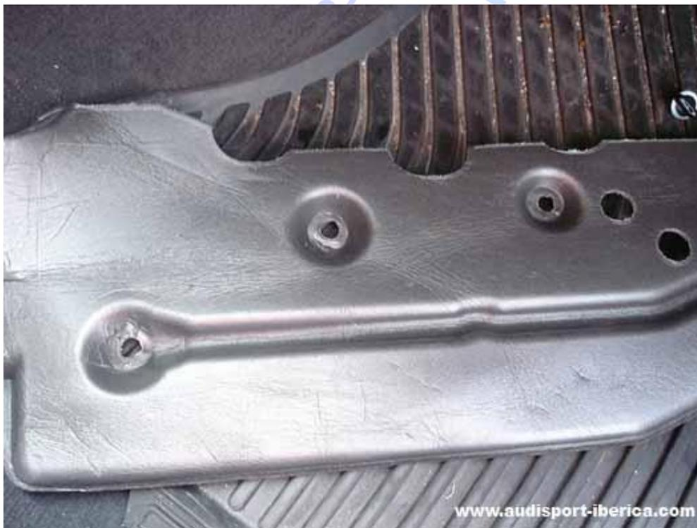
Nos encontramos una tapa de plástico blanca con una pestaña, empujamos esta pestaña hacia la derecha para desmontar la tapa y sacamos el filtro de polen usado hacia abajo:
