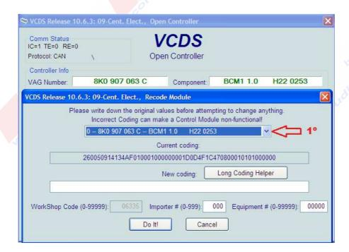
Pinchamos en la flecha hacia abajo que hay en la ventana, se abre un desplegable y seleccionamos el submódulo **2 – 8K0 955 559 – RLS** que se encarga de controlar el sensor de lluvia y luz:
