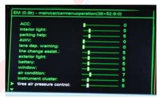
Pulsamos [RETURN] una vez que hayamos completado la configuración del MMI y reiniciamos el MMI: Pulsamos a la vez los botones de [SETUP], rueda de desplazamiento y tecla superior derecha junto a rueda de desplazamiento, a continuación dejamos de pulsar.
