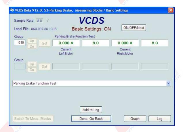
Una vez acabado el Ajuste Básico del módulo 53 de la prueba de funcionamiento conectamos el freno de estacionamiento eléctrico y borramos con el Vag-Com los fallos que hayan aparecido en los módulos [53 - Parking Brake] y [03 – ABS Brakes].
