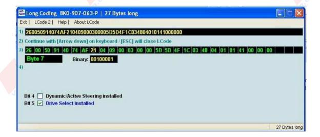
Select Control Module -> [Select] -> [09 - Cent. Elect.] [Coding - 07] -> Long Coding Helper -> Byte 8 Bit 2 – Cambiar el valor 0 por 1 en el Binary (1 = activado) -> 3º digito por la derecha Exit LCode o ESC -> [Do It!] para que acepte el New Coding -> Codificación aceptada.
