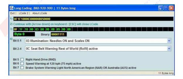
Con la codificación siguiente en el cuadro de instrumentos quedarían encendidas las agujas y se apagarían las esferas:
