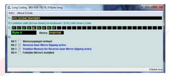
Funcionamiento de la activación: Cuando insertamos la palanca de cambios en la posición de marcha atrás con la rueda de ajuste de los espejos retrovisores en la posición derecha el espejo retrovisor derecho se inclinará hacia abajo. El espejo retrovisor derecho volverá a su posición inicial memorizada cuando circulemos hacia delante unos metros o cuando paremos el coche quitando el contacto. Este sistema no funciona cuando la rueda de ajuste está en la posición central o izquierda.
