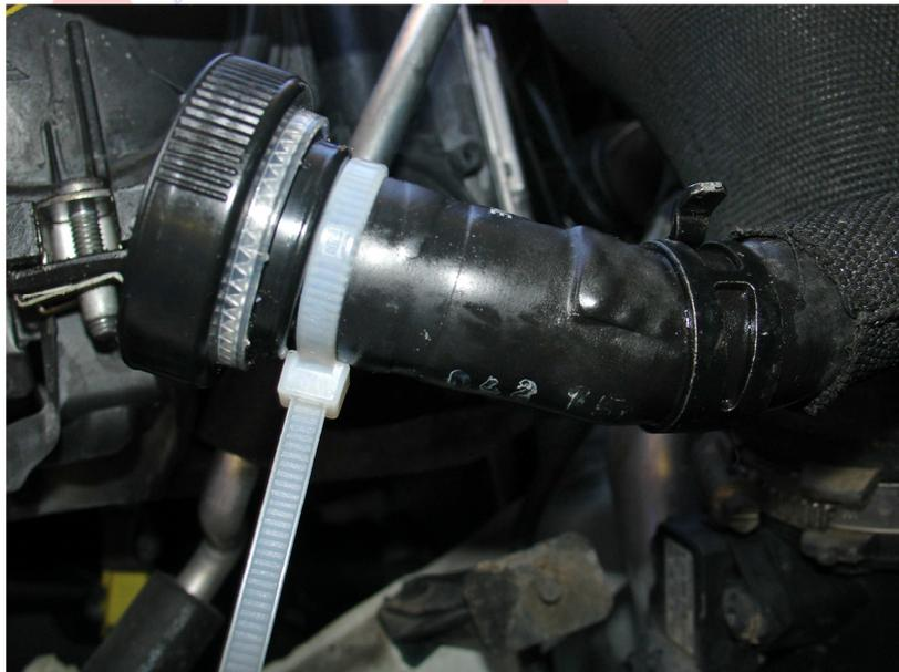
Levanto el tubo de salida y enrosco el botellón de plástico de medio litro. Lo sujeto firmemente con una brida, no vaya a derramarse el aceite. Es importante poner esa botella ahí, de manera que la podamos ver desde el puesto de conducción (con el capó levantado la podemos ver bien):
