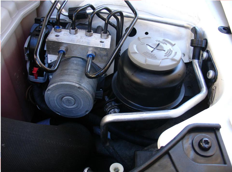
Para una sustitución del líquido, necesitamos liberar el tubo de retorno a ese reservorio. En mi caso, también solté el tubo de salida de aceite para que el cambio del fluido sea completo.
