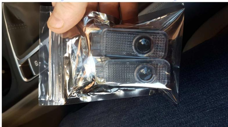
Con el destornillador plano que Audi proporciona sale bastante bien la pieza a sustituir, se saca la pieza y quitamos el cable ayudándonos de nuevo con el destornillador, ya que hay que apretar la pestaña negra que extrae la clavija. Procedemos entonces a sustituir cada luz.
