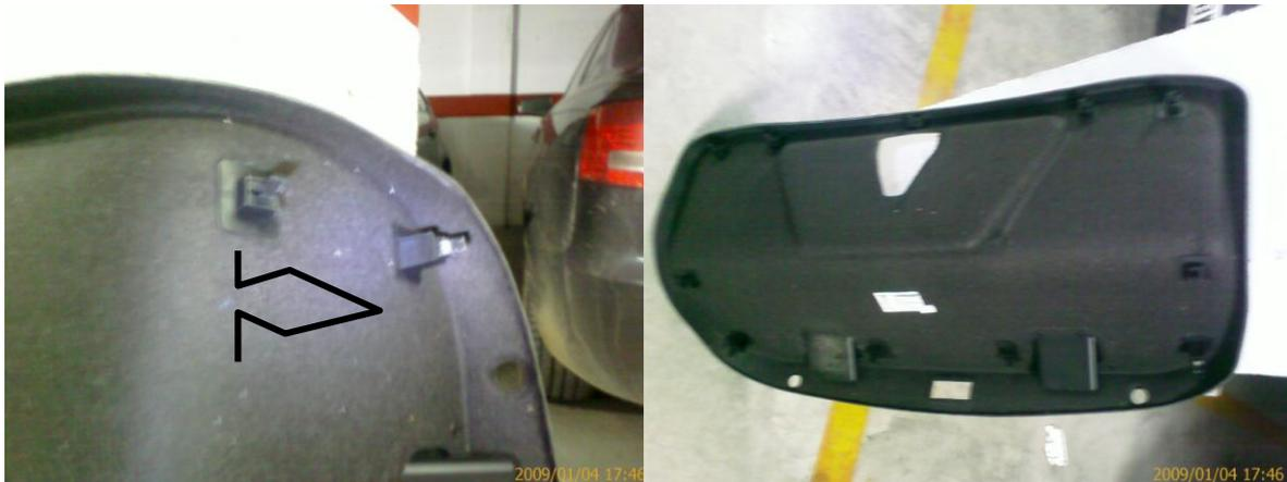
Una vez terminado el desmontaje de la protección, tenemos la cerradura a la vista y tan solo hay que remover el conector, desatornillar las dos tuercas de 8mm que la sujetan a la chapa y una vez hecho todo esto tenemos la cerradura tan solo unida con el cable de acero (freno de bicicleta) que la une al mecanismo de apertura remota del maletero. Quitamos el cable y ya tenemos la cerradura a nuestra disposición. No tengo imágenes de este proceso, pero creo que es bastante simple. Seguimos....
