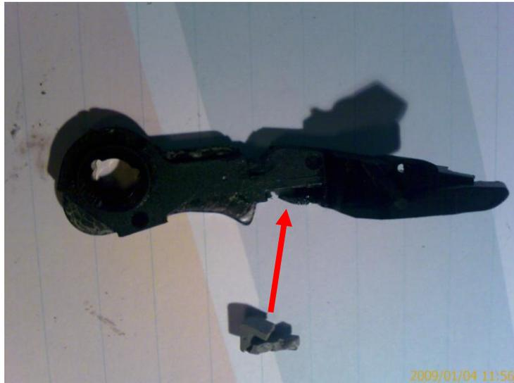
Esta goma se puede sacar con unas pinzas fácilmente con la cerradura desmontada ya que tenemos mucho acceso por la parte superior. La pieza de la imagen es la que enclava a la otra en el resalte metálico que se ve. Como podéis imaginar el eje de plástico del motor engarza en la parte alta de esta pieza.
