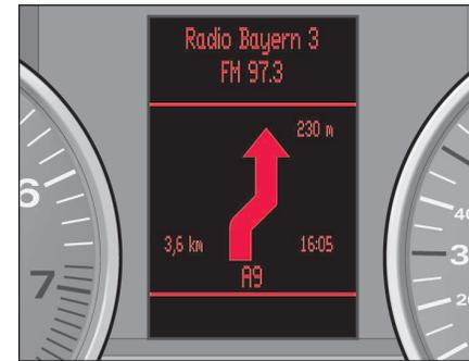
Fig. 241 Sistema de navegación: representación en la pantalla del sistema de información para el conductor
