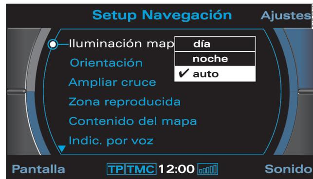
Fig. 273 Ajustes del sistema de navegación: Ajuste de la iluminación del mapa
