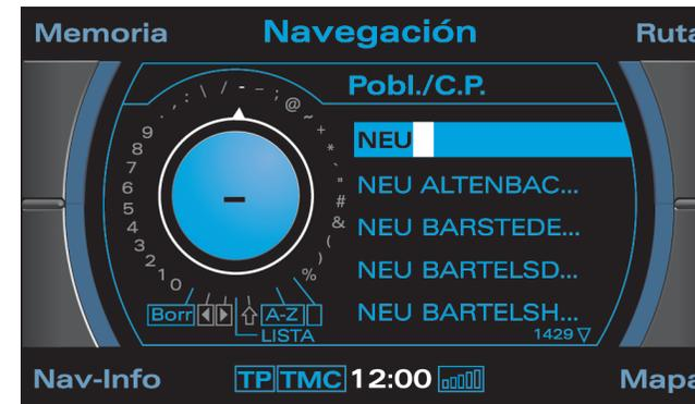
Fig. 252 Sistema de navegación: Teclado numérico con signos especiales (guion)
