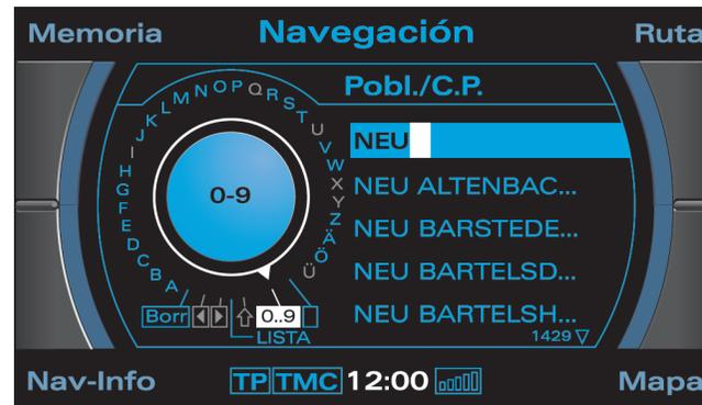
Fig. 251 Sistema de navegación: Cambiar el teclado de modo alfabético a modo numérico.
