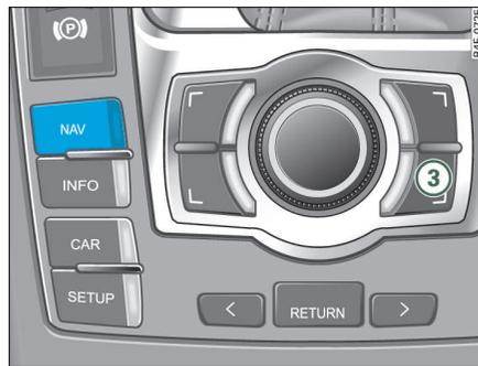
Fig. 247 Terminal del MMI: Tecla de función del sistema de navegación
