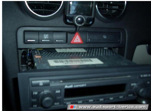
4. Conecto el conector negro(1) de arriba del todo a la clavija (hembra) roja y el conector gemelo al anterior en el sitio que estaba conectado éste(1). Sujeto la masa con la mano en la radio, reviso todo y pongo el contacto.
