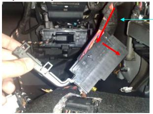
Metemos el cable rojo por el mazo de cables hasta los fusibles, nos aseguramos con un multimetro de que tenemos 12+V y volvemos a colocar el porta fusibles
