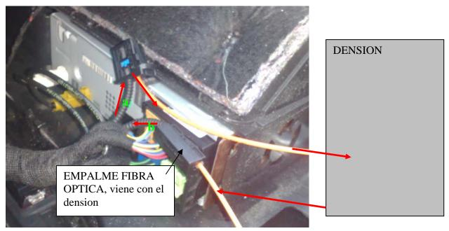
El cable a y el cable b estaban juntitos en la clavija, metidos en el radio-cd, hemos sacado el b y lo hemos empalmado con el que va en el mismo sentido del dension, y en
