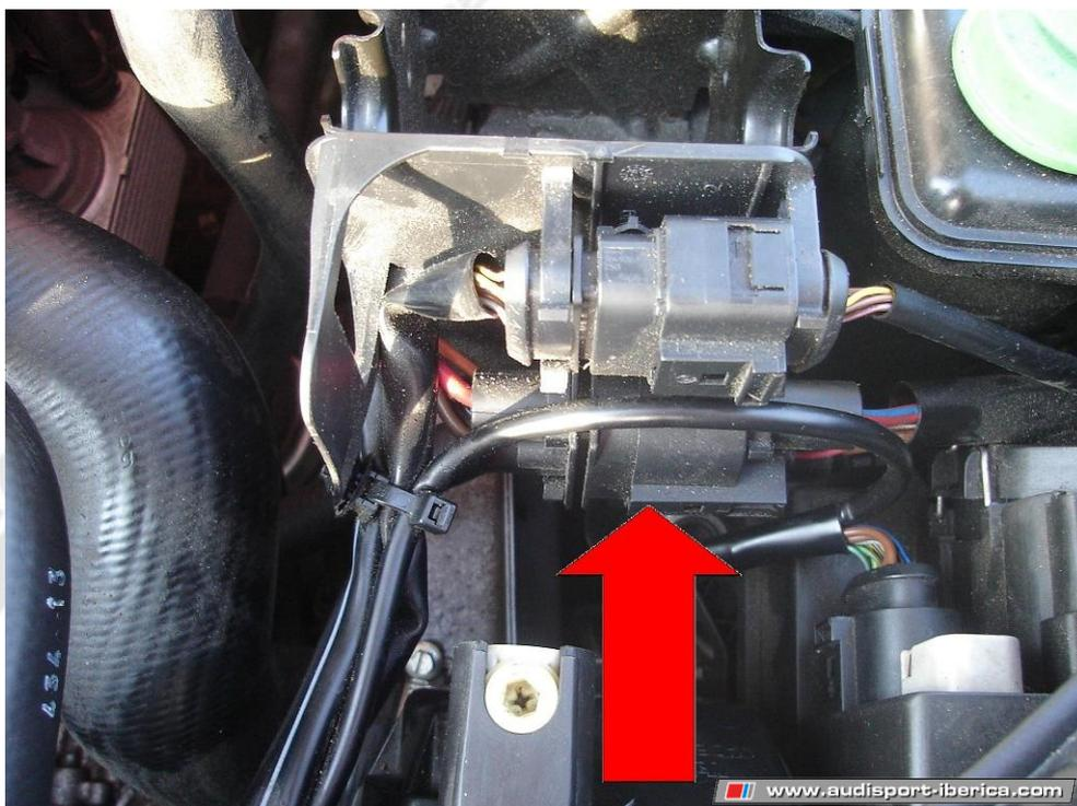
3. Separamos las pestañas laterales y con la ayuda de un destornillador plano presionamos la pestaña inferior para que pueda salir dicho artilugio.
