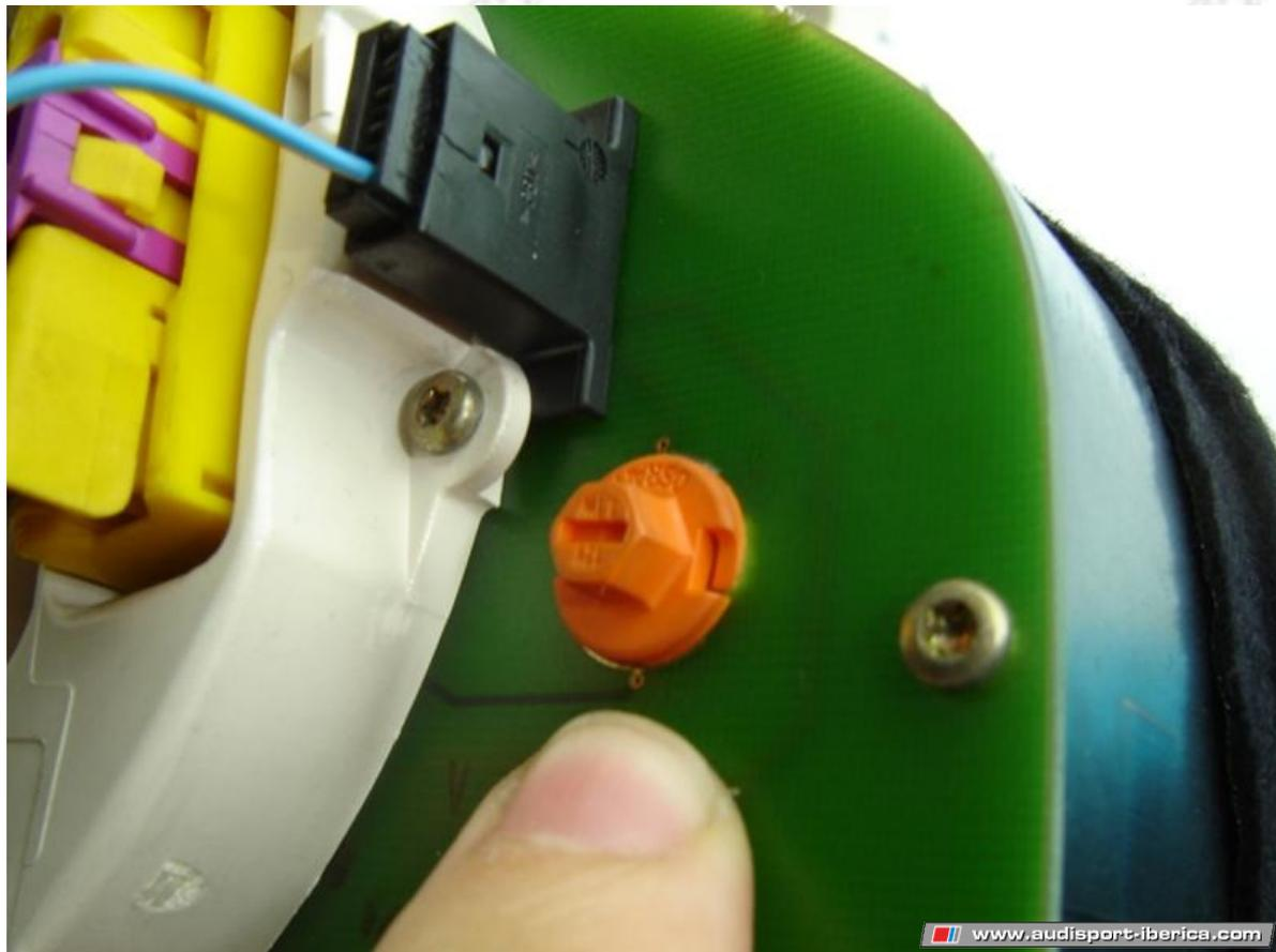
9. Saquemos la vela aflojándola con un destornillador plano (sólo media vuelta es suficiente).
