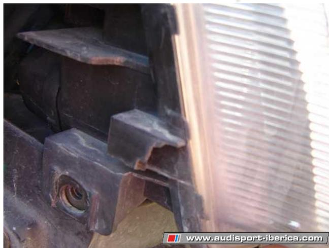
7. Sacamos un poco el faro tirando hacia afuera, quedando libres los cables y enchufes. Quitamos los enchufes (son 3), uno de regulación del faro, otro que da corriente para la iluminación, y otro para el intermitente.
