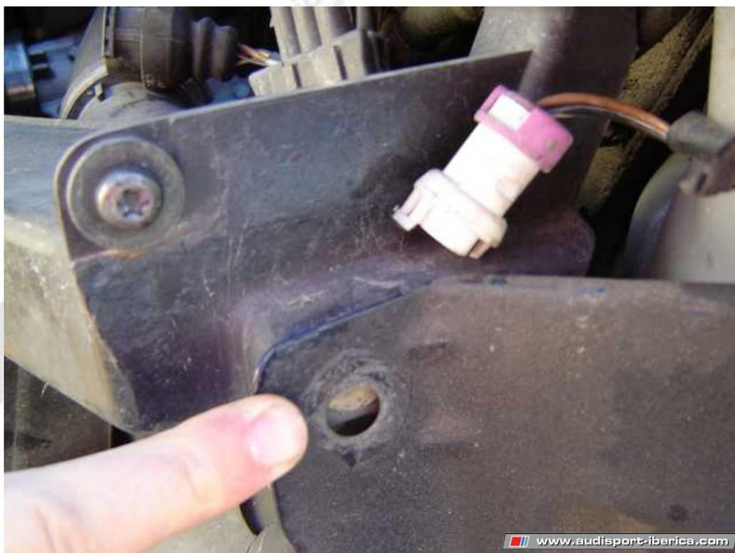
18. Quidemos los 4 tornillos de torx (2 a cada lado) que sujetan el frontal a la carrocería por la parte superior.
