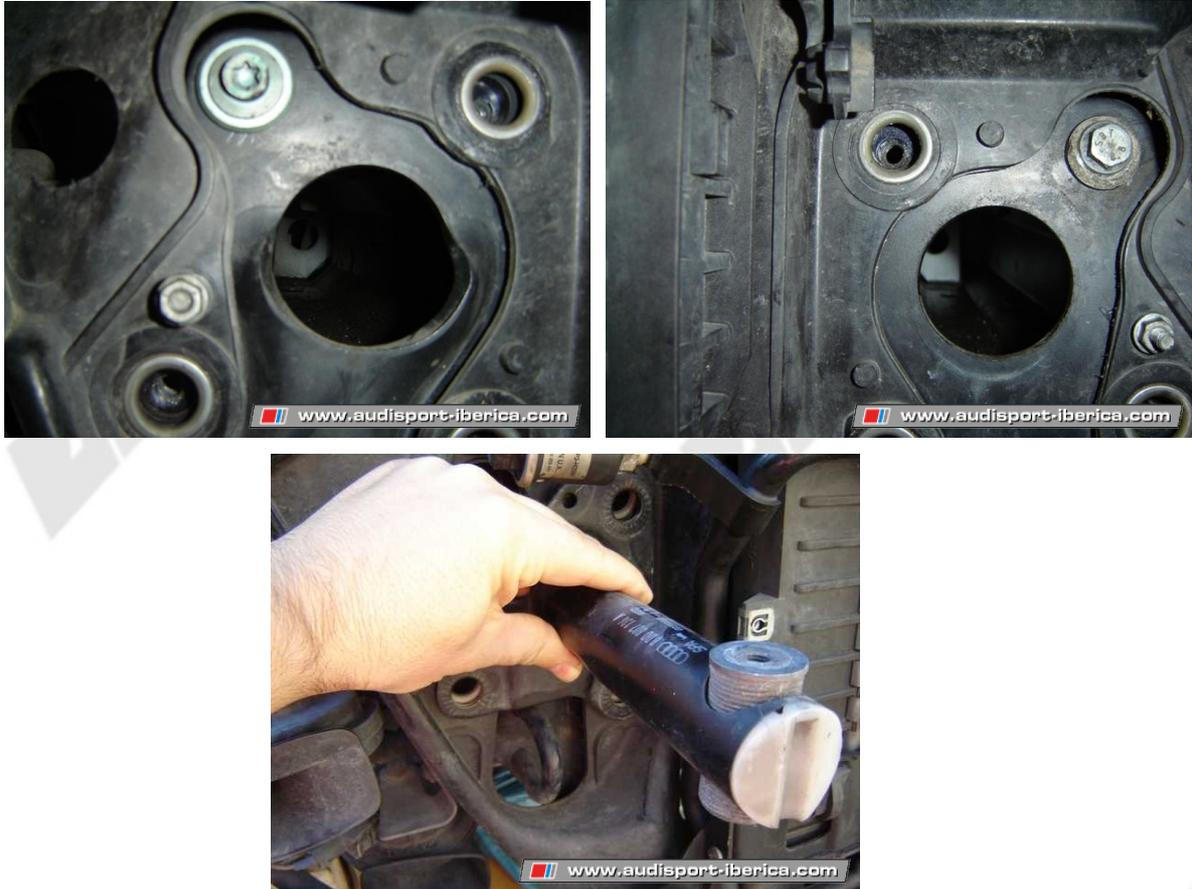
23. Tiramos del frontal y lo desplazamos a la izquierda del coche (la parte derecha según vemos el coche de frente), colocándolo exactamente apoyado de la rueda izquierda de manera que los cables que siguen conectados no los tengamos que desenchufar.
