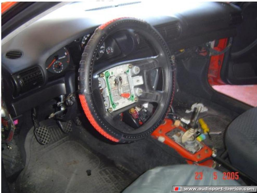
32. Airbag volante colocado, el del pasajero también está colocado y conectado. También ya se han conectado todos los interruptores del panel frontal, así como radio, y climatizador.
