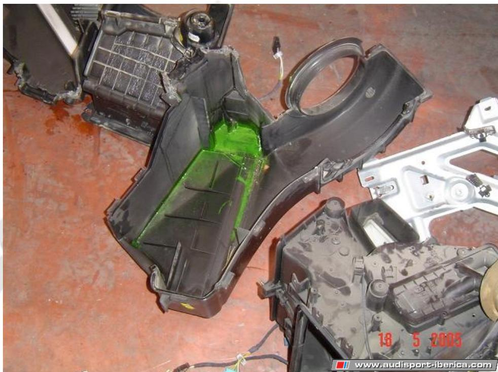
15. Y aquí tenéis el jodido evaporador (podéis ver como está aún contaminado por el líquido detector) de aluminio puro pero muy frágil.
