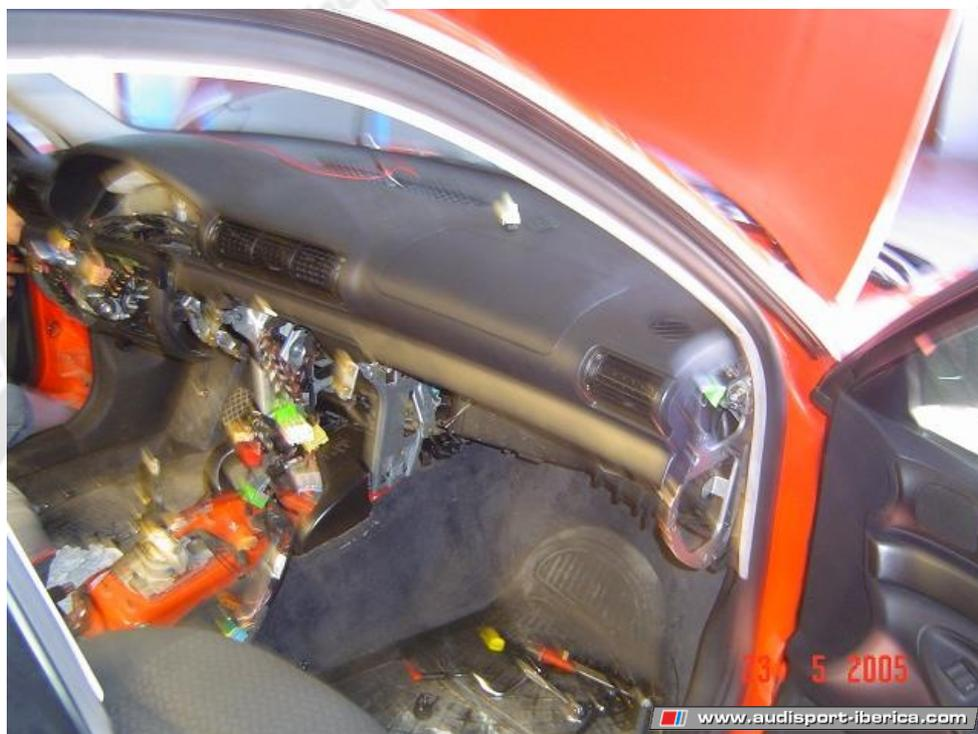
24. Preparando caja interconexión de centralita con cajaportarelés y fusibles.
