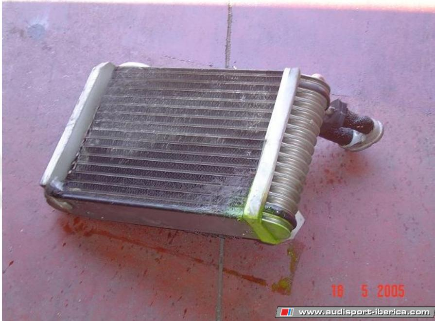
16. Tremendo aspecto de “mi tomatito”. Bueno ya está el evaporador en un colega que posiblemente pueda repararlo, si no pues ya tengo algo buscado a buen precio, como yo digo “con mucho descuento y muy poco IVA”. El desmontaje de todo con mimo y controlándolo todo duró unas tres horas. Calculamos que el montaje será cómodo y distraído al tener buenas notas de todo.
