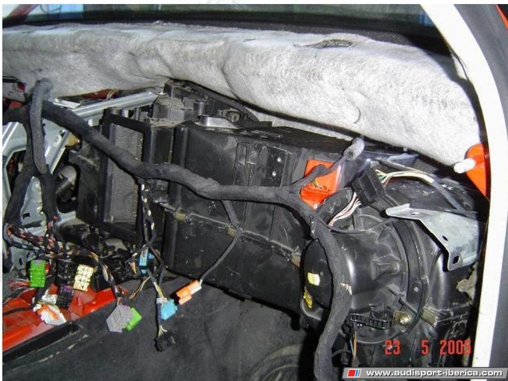
20. Ahora ya toca colocar todo el mazo de cables en sus correspondientes grapas y dejarlas preparadas para conectar en su sitio. Cuidadín de no dejar ninguno pillado, ni sin control, tubitos de vacío, etc.
