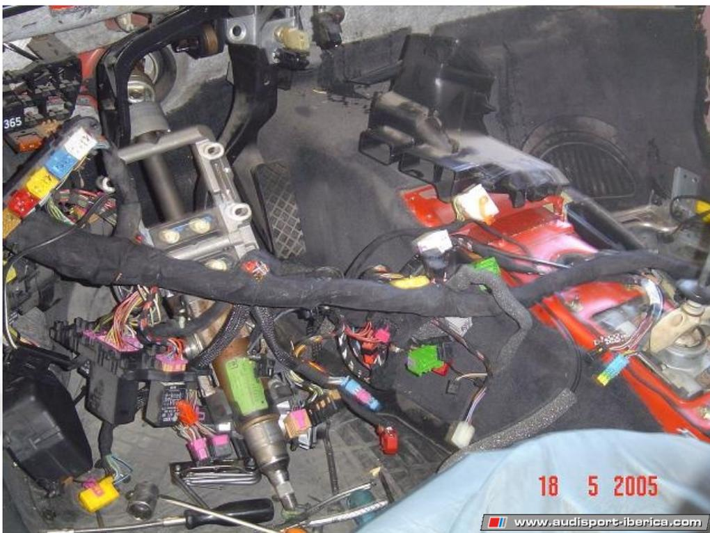
11. Aquí tenéis el lugar de la ecu o centralita desmontada para poder quitar la caja de conexiones.
