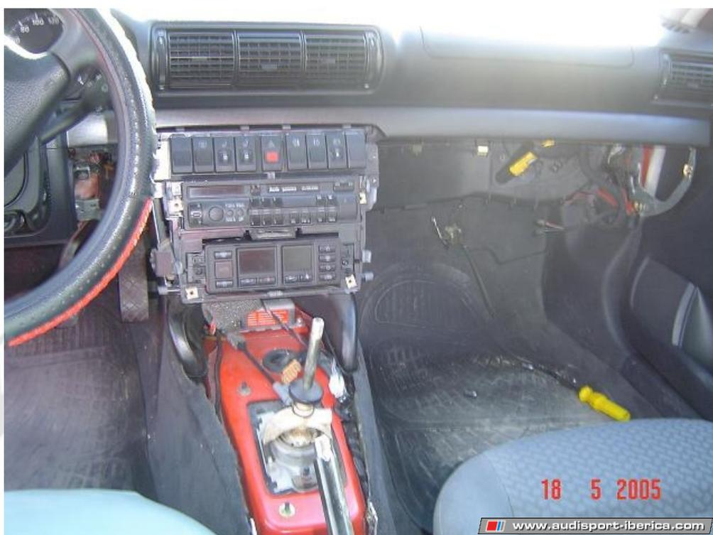
3. Ya desmontado el airbag y empezando a desmontar volante.
