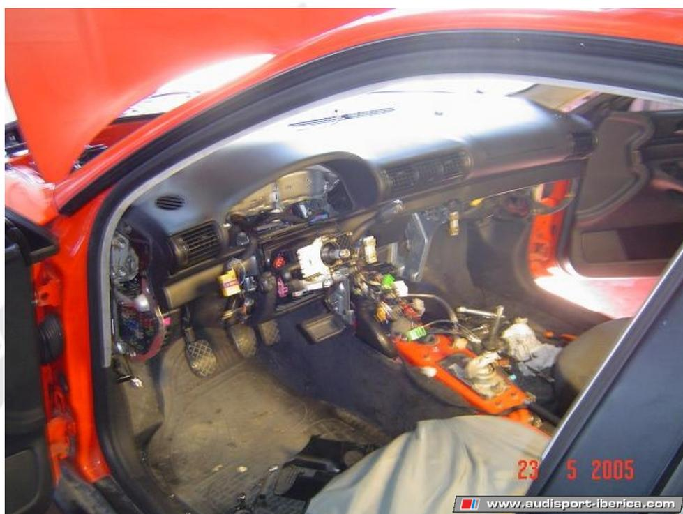
29. Conectando centralita, relé 209, fusible de alimentación y tubo de vacío de la centralita. Todos estos tubos de vacío se recomienda colocarlos nuevos.
