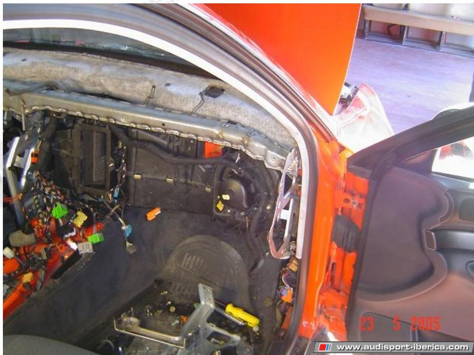
22. Aquí con la columna de dirección y soportes del frontal montados.
