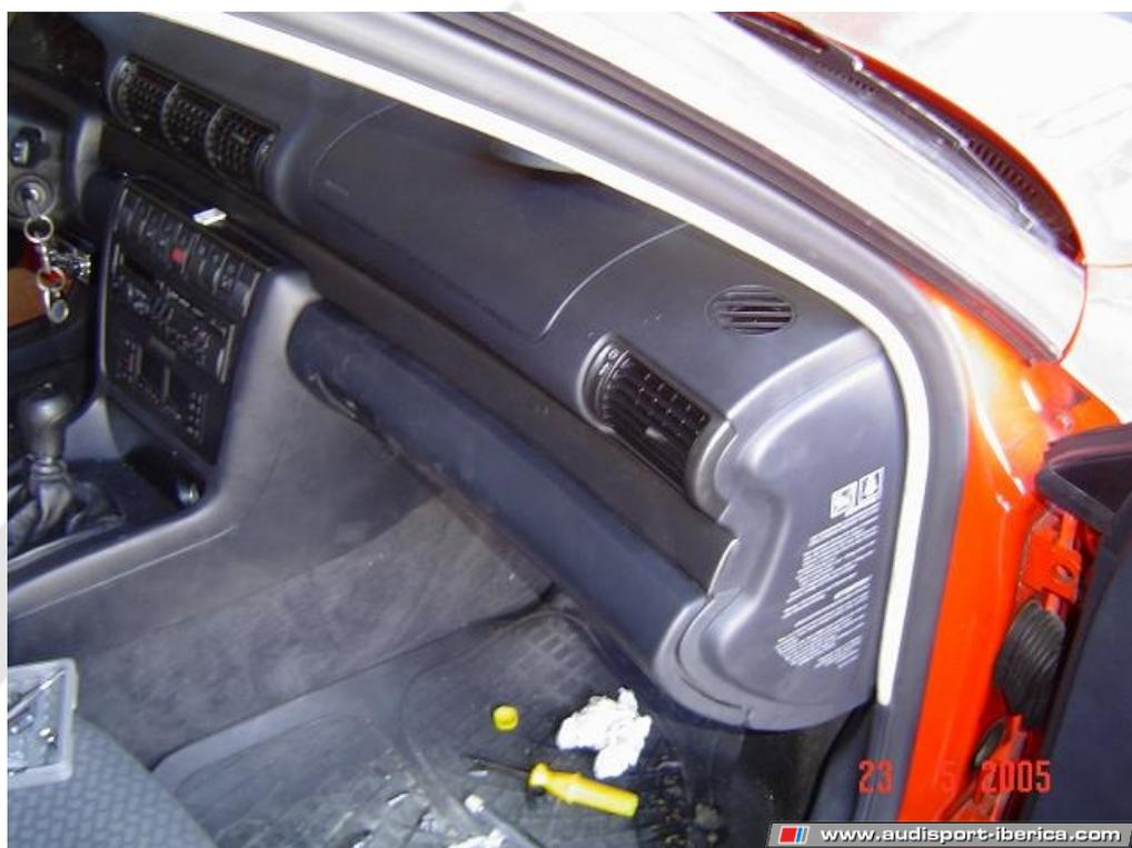
39. Colocación tapa caja fusibles y conexión de la emisora de banda ciudadana.
