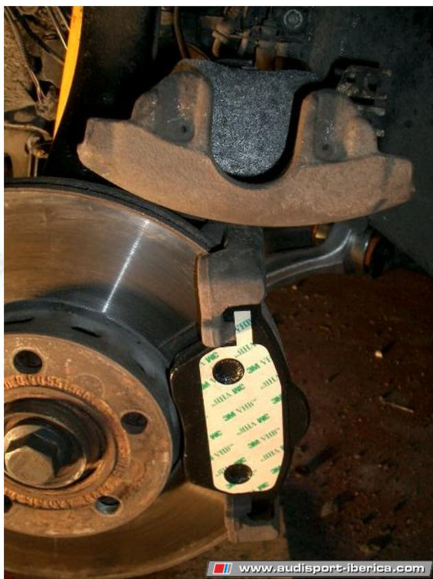
7. Ahora colocamos la pinza, atornillamos los dos torx que antes desenroscamos y le colocamos el tapón de goma.
