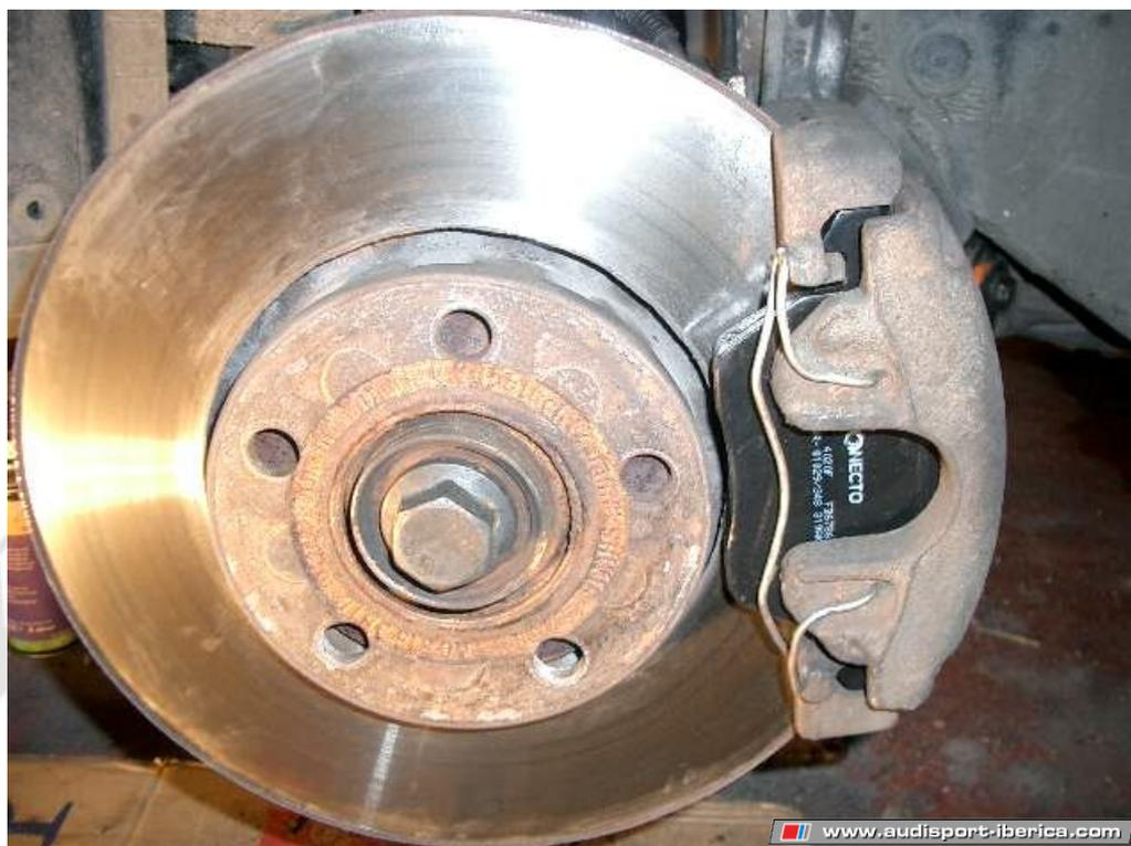
9. Y colocamos el conector del testigo de desgaste de la misma forma que lo quitamos.
