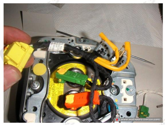
8. Ahora, con el destornillador de punta fina, muy fina, subimos los frenos de los conectores verde y naranja (tapitas amarillas) hacia arriba y sacamos los conectores. Desconectamos los cables que tenemos con terminales faston, uno es más grande que el otro, con lo que no hay confusión para montarlos. Ahora montamos el nuevo cable.
