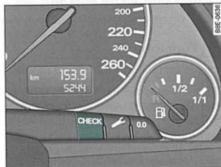
Fig. 19 Detalle del cuadro de instrumentos: Tecla CHECK
