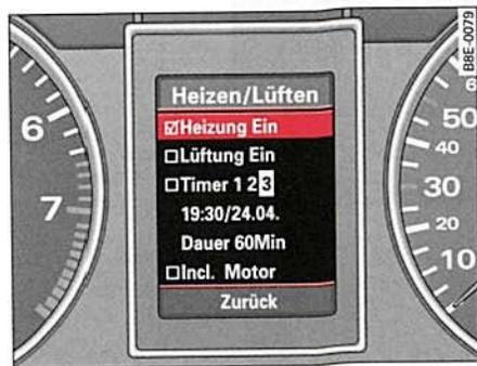
Fig. 132 Puesto de conducción: Pantalla del FIS, menú Heizen/Lüften (Calentar/ventilar), se ha seleccionado el TIMER 3 (Temporizador 3)
