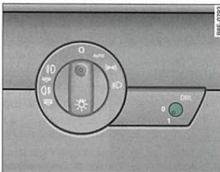
Fig. 67 Conmutador de la luz de marcha diurna
