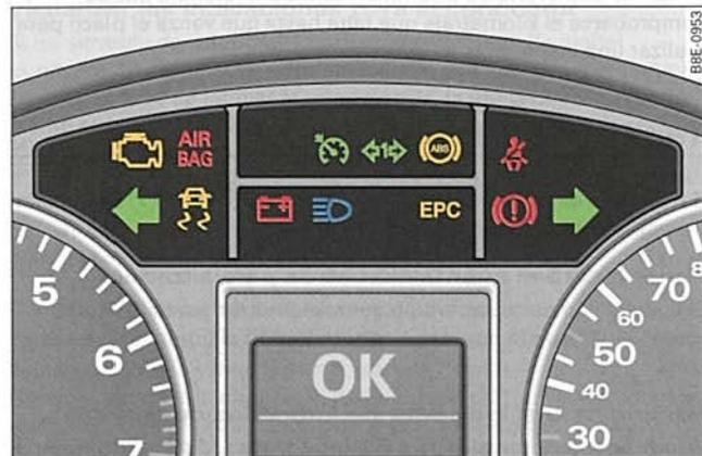
Fig. 8 Cuadro de instrumentos con testigos de control
