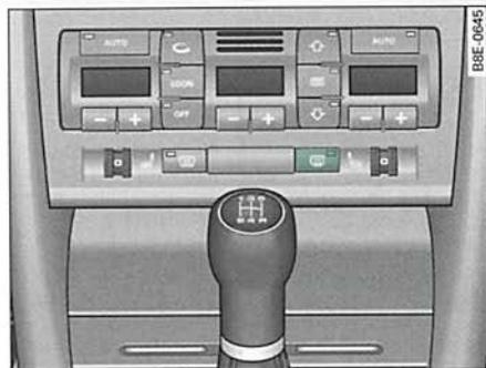
Fig. 75 Interruptor para luneta térmica
