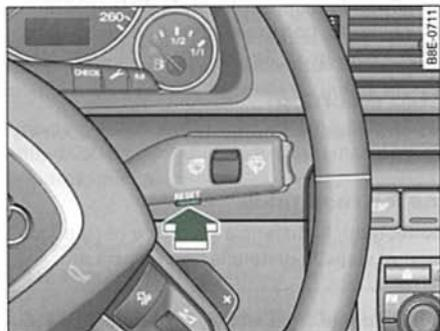
Fig. 25 Palanca del limpiaparabrisas: Tecla Reset
