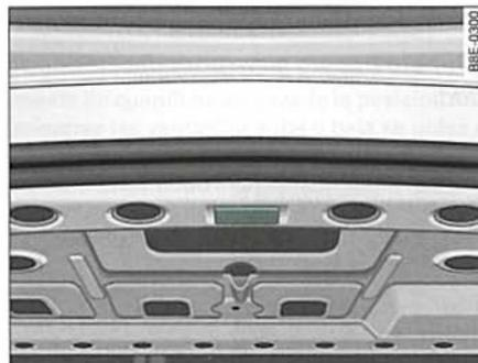
Fig. 74 Detalle de la parte superior del maletero: Iluminación del maletero
