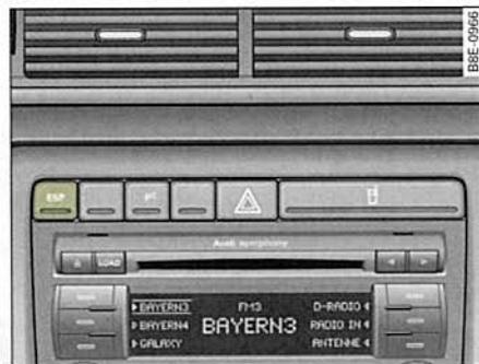
Fig. 192 Consola central con el interruptor del ESP
