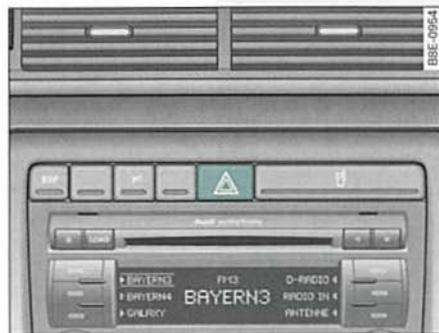
Fig. 69 Consola central: Interruptor para intermitentes simultáneos de emergencia
