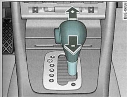
Fig. 153 Consola central: Cambiar las marchas manualmente (tiptronic)
