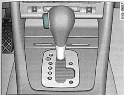
Fig. 150 Detalle de la consola central: Palanca selectora con tecla de bloqueo
