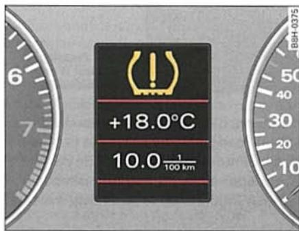
Fig. 39 Pantalla: Presión de los neumáticos moderadamente inferior
