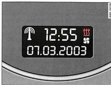
Fig. 131 Puesto de conducción: Display del reloj digital, temporizador activado
