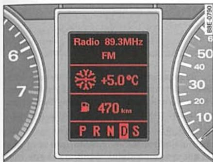
Fig. 9 Puesto de conducción: Pantalla digital del cuadro de instrumentos
