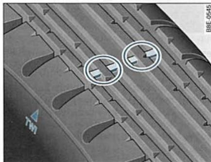
Fig. 222 Dibujo del neumático: Indicadores de desgaste
