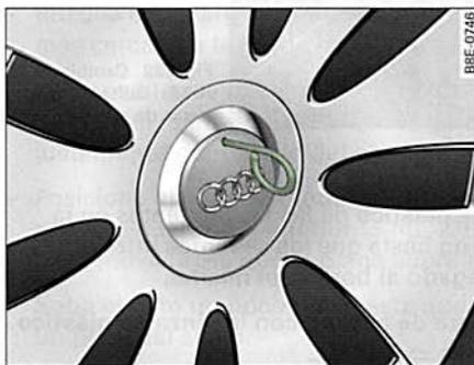
Fig. 231 Cambio de rueda: Retirar el embellecedor de la rueda
