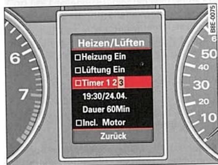
Fig. 128 Puesto de conducción: Pantalla del FIS, menú Heizen/Lüften (Calentar/ventilar), se ha seleccionado el Timer 3 (Reloj temporizador 3)
