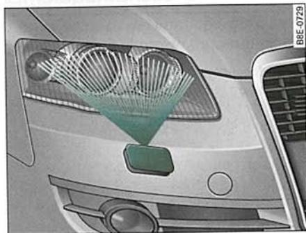
Fig. 80 Faro con eyector de lavado desplegado
