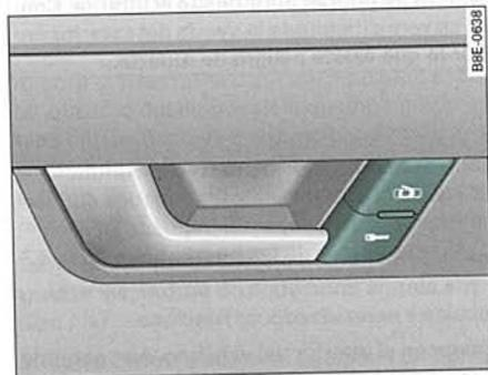
Fig. 48 Detalle de la puerta del conductor: Conmutador del cierre centralizado
