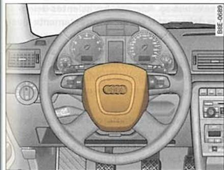
Fig. 173 Airbag del conductor en el volante
