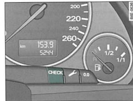
Fig. 20 Detalle del cuadro de instrumentos: Tecla CHECK
