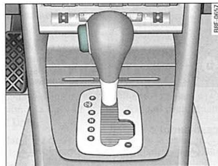
Fig. 144 Detalle de la consola central: Palanca selectora con tecla de bloqueo
