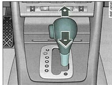
Fig. 147 Consola central: Cambiar las marchas manualmente (tiptronic)
