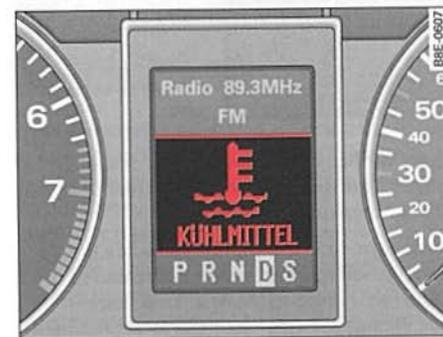
Fig. 16 Pantalla: Aviso sobre el nivel del líquido refrigerante
