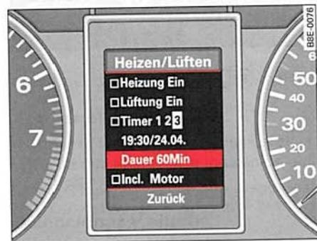
Fig. 129 Puesto de conducción: Pantalla del FIS, menú Heizen/Lüften (Calentar/ventilar), se ha seleccionado la duración de funcionamiento del temporizador 3
