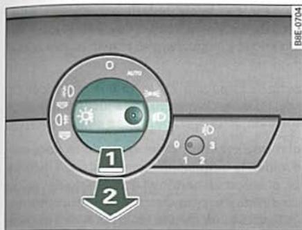
Fig. 62 Detalle del tablero de instrumentos: Conmutador de las luces
