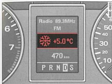
Fig. 11 Pantalla: Indicador de temperatura exterior
