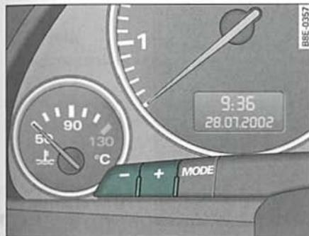
Fig. 65 Iluminación de los instrumentos
