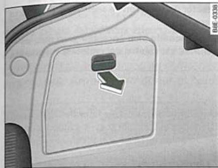
Fig. 102 Maletero: Recubrimiento lateral con compartimento cerrado
