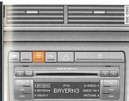
Fig. 182 Testigo de advertencia si el airbag del acompañante se ha desactivado por medio del interruptor de llave
